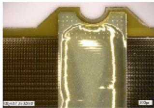
**Figure 8 : Delamination on thermal contact pads.**
